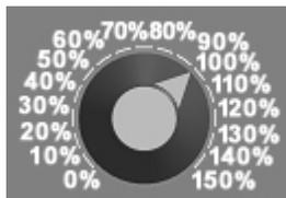
调节数控程序运行中的进给速度，调节范围从0~150%。置光标于旋钮上，点击鼠标左键转动。
