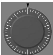
把光标置于手轮上，按鼠标左键，移动鼠标，手轮顺时针转，机床往正方向移动，手轮逆时针转，机床往负方向移动。
