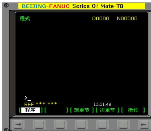
图 4.2-4 FANUC Oi-T(车床)数字及符号输入
