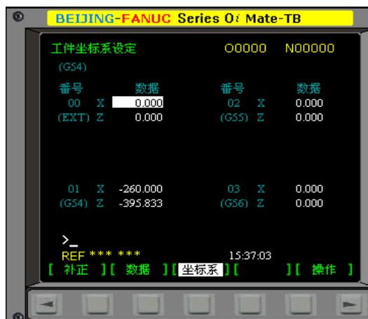
图 4.2-7 FANUC Oi-T(车床)
