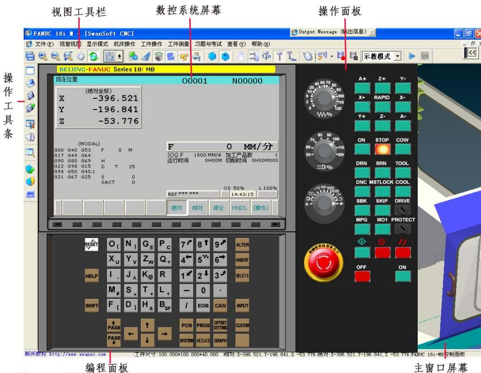
图 1.2-5 FANUC 18iM(车床)
