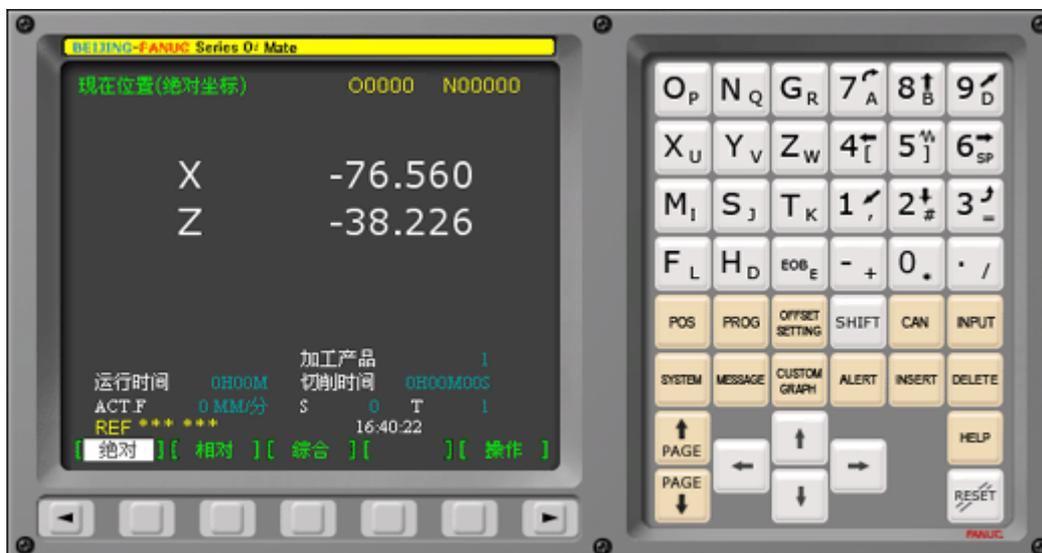
图 4.2-2 FANUC 0i (车床) 面板
