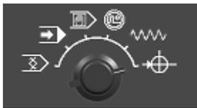
模式选择：编辑，循环，MDA，手轮，手动，原点返回
