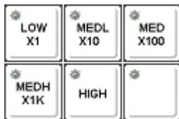
选择移动机床轴时每一步的距离：×1 为 0.001 毫米，×10 为 0.01 毫米，×100 为 0.1 毫米，×1K 为 1 毫米。置光标于旋钮上，点击鼠标左键选择。
