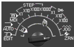
EDIT (编辑) /AUTO (循环) /MDI (手动数据输入) /STEP (增量进给) /手轮倍率调整/JOG (手动) /ZRN (回参考点)
