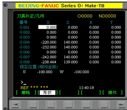
图 4.2-9 FANUC Oi-T(车床)刀具补偿页面
