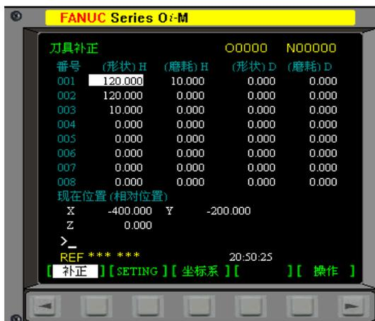
图 4.2-8 FANUC Oi-M(铣床)刀具补偿页面
