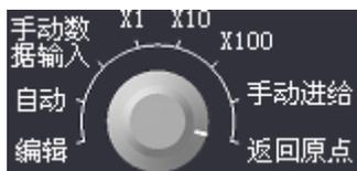
编辑/自动/手动数据输入/增量进给倍率/手动进给/返回原点
