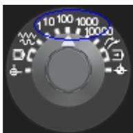
选择移动机床轴时，每一步的距离：1 为 0.001 毫米，10 为 0.01 毫米，100 为 0.1 毫米，1000 为 1 毫米，10000 为 10 毫米。置光标于旋钮上，点击鼠标左键选择。
