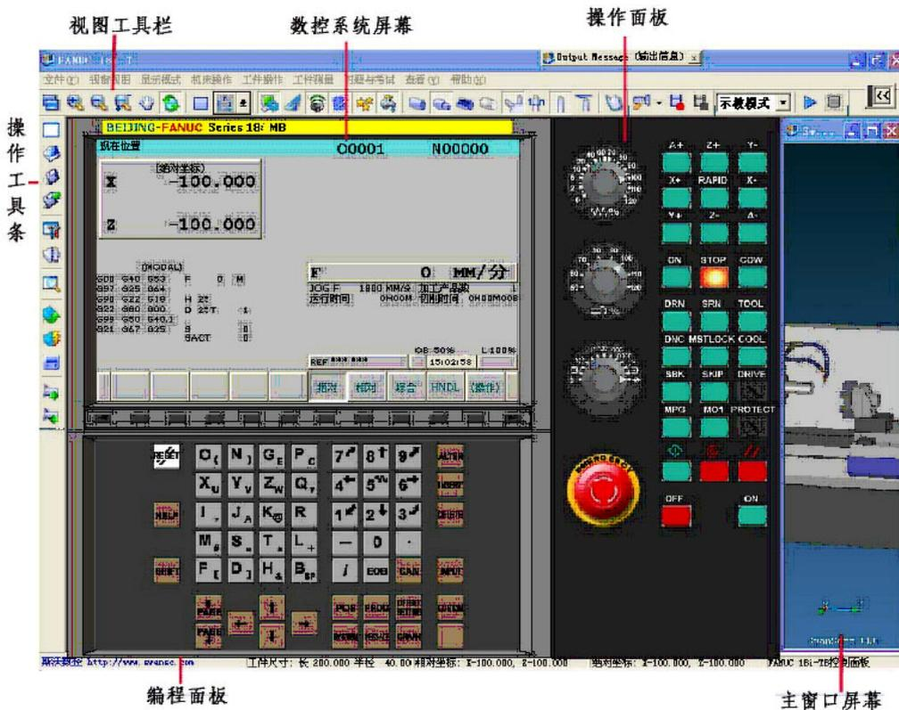
图 1.2-6 FANUC 18iT(车床)
